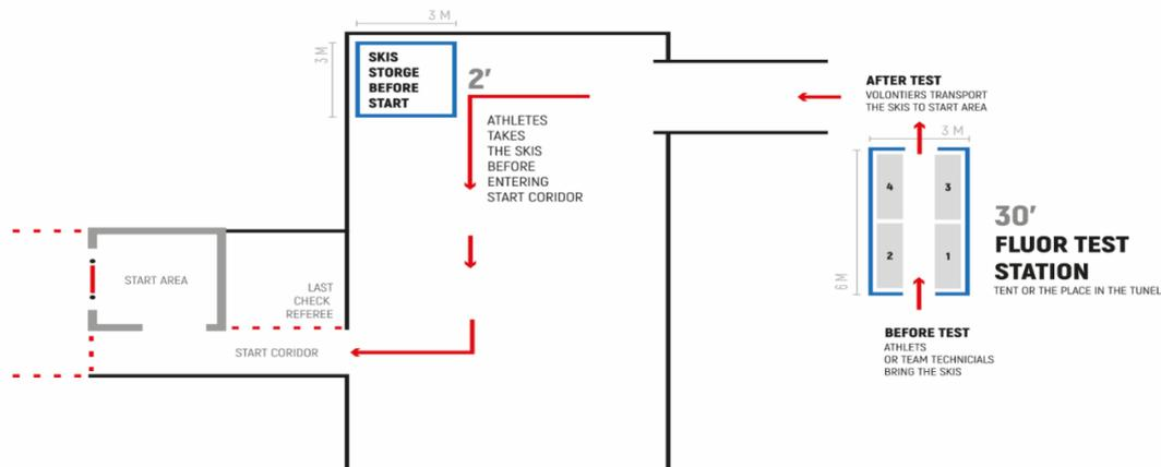
会場には 4 つの独立したステーションを設置する必要があります。各ステーションには、別のコンピュータに接続されたスライダー システム上の専用デバイス (Bruker Alpha II) が装備されています。許可された人物のみが立ち入ることができます。
